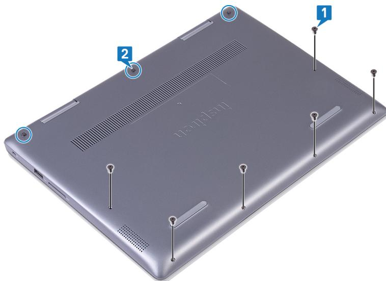
3. Com os dedos, force a tampa da base para a retirar do conjunto do teclado e apoio para as mãos começando pelo canto superior esquerdo.
